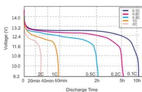
TEMPERATURE DISCHARGE CHARACTERISTICS 25°C
